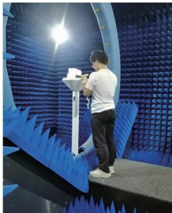
海南省某科技企业 0.6GHz~8GHz 23探头近场测量系统
